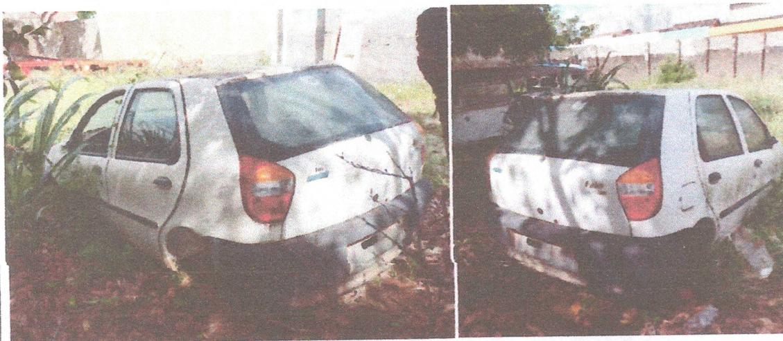
SITUAÇÃO DO VEÍCULO: SEM MOTOR, SEM CAIXA DE MARCHA, SEM PNEUS (SUCATA). VEÍCULO INUTILIZÁVEL, RECUPERAÇÃO DO BEM ECONOMICAMENTE INVIÁVEL. DESSA FORMA, A COMISSÃO DE AVALIAÇÃO, APÓS VISTORAR O VEÍCULO, CONCLUI PELA INSERVIBILIDADE DO BEM. VEÍCULO, CONCLUI PELA INSERVIBILIDADE DO BEM.
