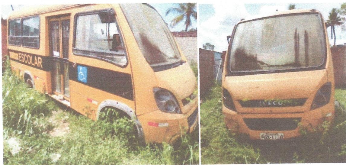
**SITUAÇÃO DO VEÍCULO: COM MOTOR, COM CAIXA DE MARCHA. VEÍCULO INUTILIZÁVEL, RECUPERAÇÃO DO BEM ECONOMICAMENTE INVIÁVEL. DESSA FORMA, A COMISSÃO DE AVALIAÇÃO, APÓS VISTORAR O VEÍCULO, CONCLUI PELA INSERVIBILIDADE DO BEM.**
