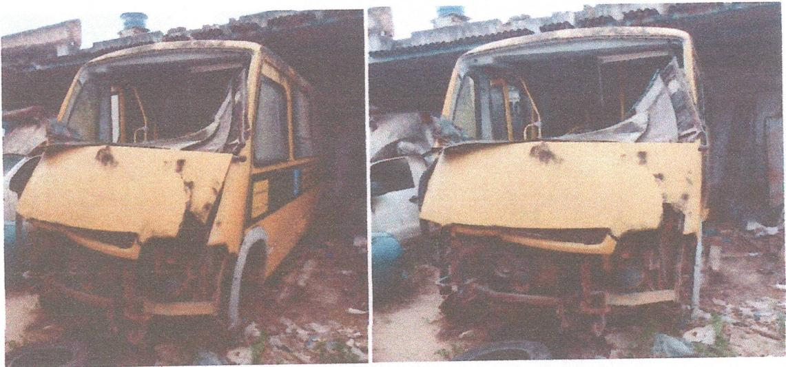
**SITUAÇÃO DO VEÍCULO:** COM MOTOR FALTANDO ALGUMAS PEÇAS, COM CAIXA DE MARCHA. **SITUAÇÃO: PARADO** VEÍCULO INUTILIZÁVEL, RECUPERAÇÃO DO BEM ECONOMICAMENTE INVIÁVEL. DESSA FORMA, A COMISSÃO DE AVALIAÇÃO, APÓS VISTORAR O VEÍCULO, CONCLUI PELA INSERVIBILIDADE DO BEM.
