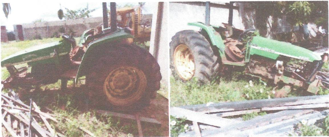
**SITUAÇÃO DO TRATOR: MOTOR FALTANDO ALGUMAS PEÇAS, COM CAIXA DE MARCHA, COM PNEUS TRASEIRO, SEM PNEUS DIANTEIRO VEÍCULO INUTILIZÁVEL, RECUPERAÇÃO DO BEM ECONOMICAMENTE INVIÁVEL. DESSA FORMA, A COMISSÃO DE AVALIAÇÃO, APÓS VISTORAR O VEÍCULO, CONCLUI PELA INSERVIBILIDADE DO BEM.**
