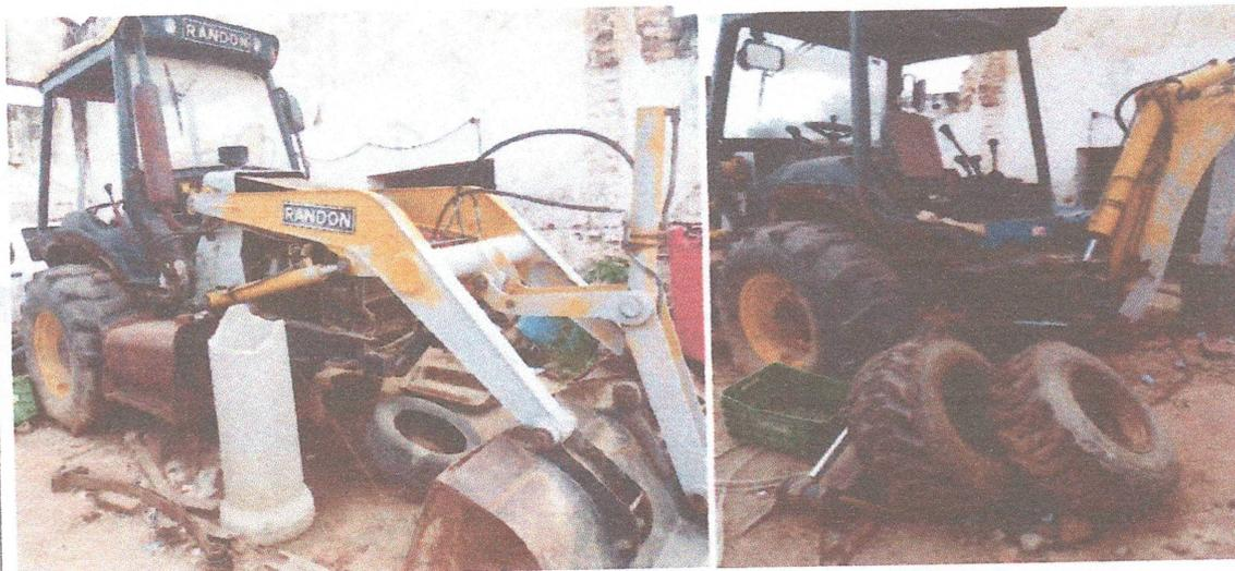
SITUAÇÃO DO TRATOR: COM MOTOR AVARIADO, PARTE DO EIXO DIANTEIRO DESMONTADO. VEÍCULO INUTILIZÁVEL, RECUPERAÇÃO DO BEM ECONOMICAMENTE INVIÁVEL. DESSA FORMA, A COMISSÃO DE AVALIAÇÃO, APÓS VISTORAR O VEÍCULO, CONCLUI PELA INSERVIBILIDADE DO BEM.
